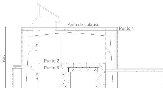
Figura 12. Detalle de puntos seleccionados para la aplicación de la ecuación de conservación de energía, Fuente: (Défaz, 2020)
