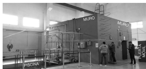
Figura 2. Estado del Irradiador de Cobalto 60, Fuente: (Défaz, 2020)
