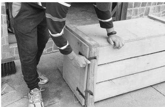
Figura 12. Levantamiento de seguros de la puerta principal
