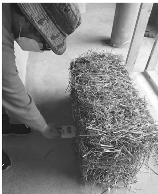
Figura 16. Medición humedad de los fardos
