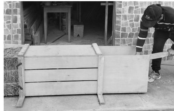
Figura 13. Empuje para retiro del fardo de la máquina mediante empuje de la palanca principal
