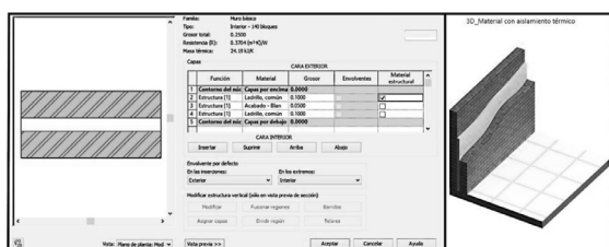
Figura 10. Propiedades térmicas de la mampostería utilizada en la edificación. Fuente: Elaboración propia
