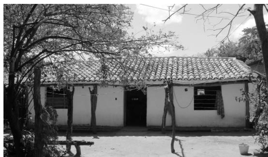
Figura 7. Tipologías de viviendas reconstruidas posdesastre en Ixtepec. Vivienda de bahareque asesorada por voluntarios (60 m<sup>2</sup>-120 m<sup>2</sup>, muros de bahareque, estructura de madera, techo de tejavana, baño y cocina interior, optativo).
