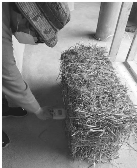
Figura 16. Medición humedad de los fardos
