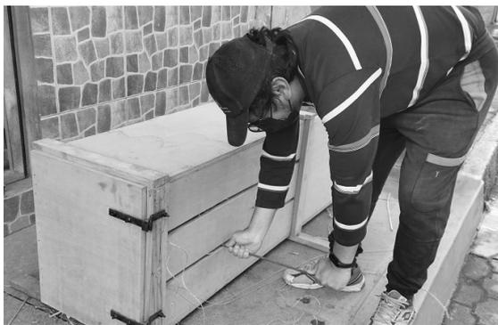
Figura 10. Insertado de los hilos por las guías de la máquina enfardadora
